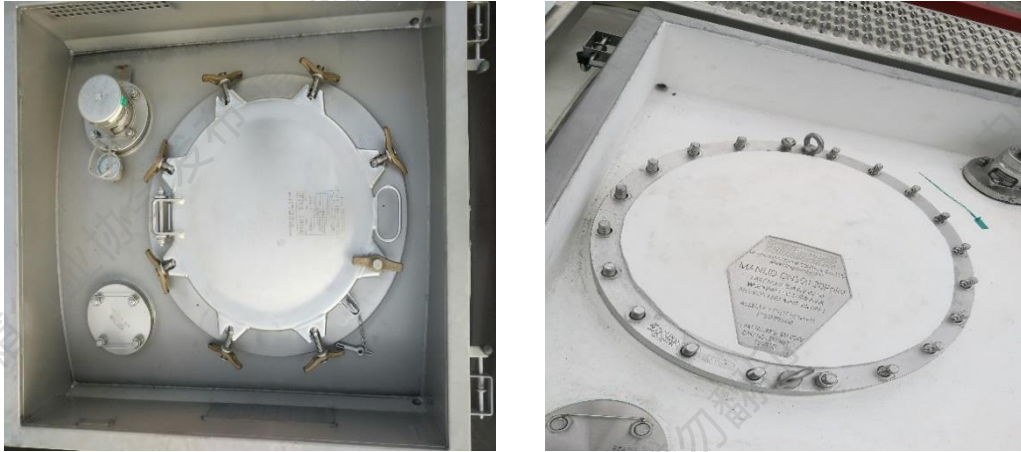
图4 罐箱快开式人孔和法兰式人孔示意
